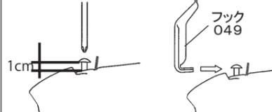
車両のネジ穴4ヶ所に付属ネジをネジ頭から1cm位残すようにプラスドライバーで締込む。車両と付属ネジのスキマにフックの切欠部を差込む。
