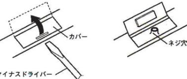
マイナスドライバー等で車両に傷をつけないようにカバーを開ける。車両にマイナスネジが付いている場合は取外して大切に保管する。
