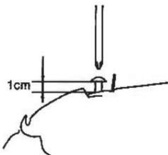
2. 車両のネジ穴4ヶ所に付属ネジをネジ頭から1cm位残すようにプラスドライバーで締め込む。
