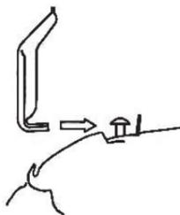
3. 車両と付属ネジのスキマにフックを切り欠き部を差込む
