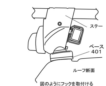
●ノブを締付けると、ベースが多少外側にずれ、図ようになります。
