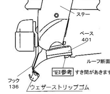
●ノブを締付けると、ベースが多少外側にずれ、図ようになります。
