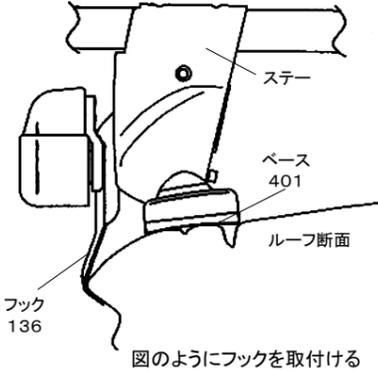
●ノブを締付けると、ベースが多少外側にずれ、図ようになります。
