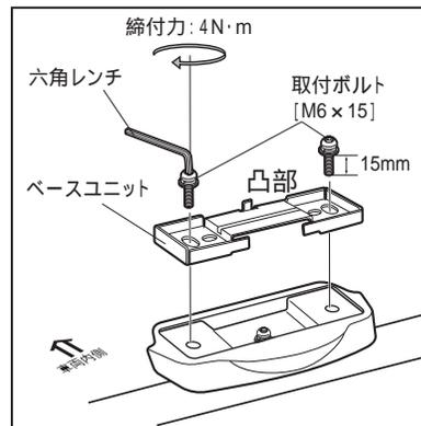
**1** 取付けたクッションベース・ベースブラケットの上にベースユニットを置き、キャリア本体付属の取付ボルト[M6x15]を六角レンチで交互に固くなるまで締付けます。
